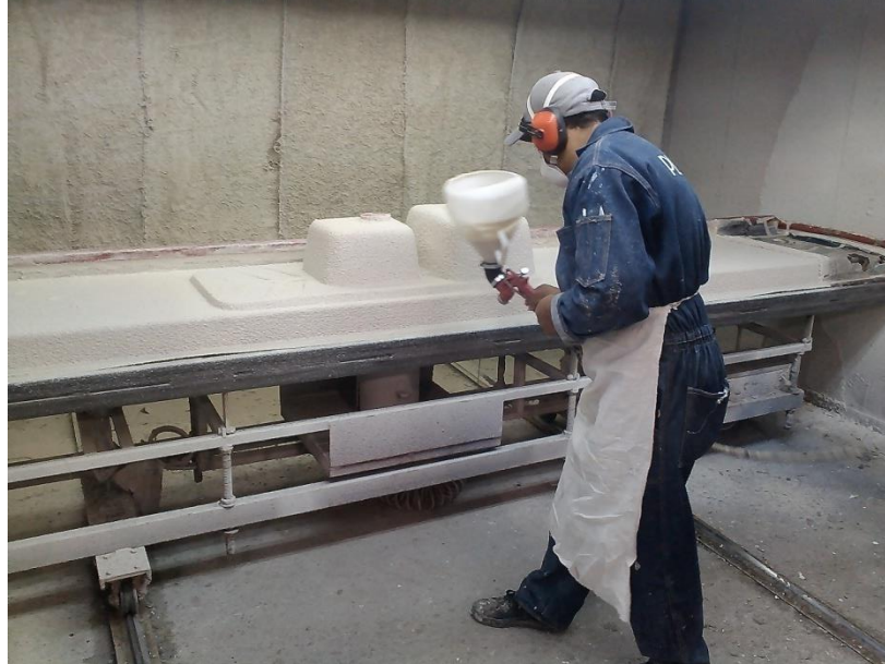
Figura 9: Proceso de sopleteado en el área de Fundición
