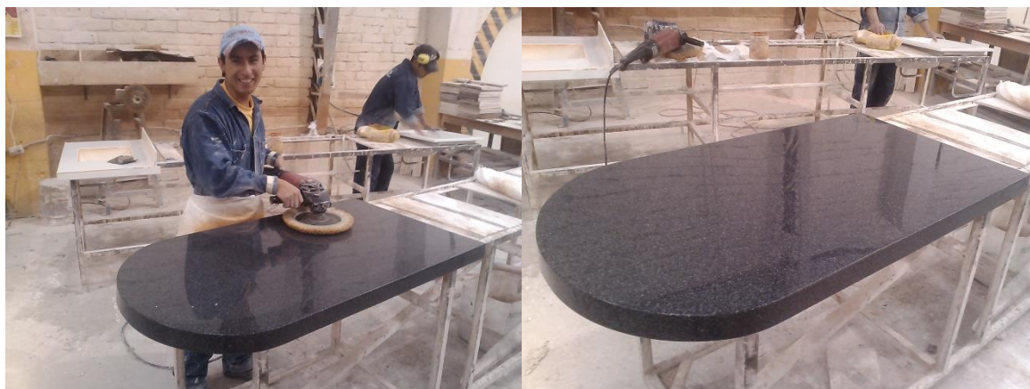
Figura 11: Proceso de abrillantado de mesones en el área de Terminado
