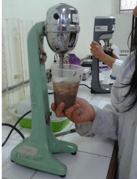
Figura 2. Pasta saturada para pruebas de pF Fuente: Loja, Méndez 2015
