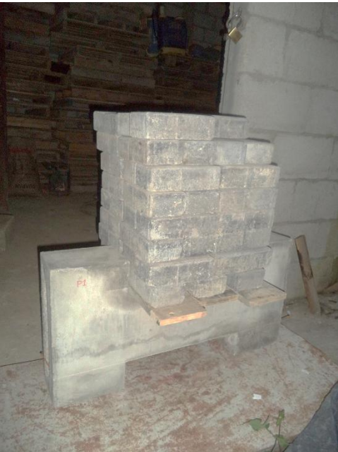
Foto. 29. Ensayo de carga progresiva.
