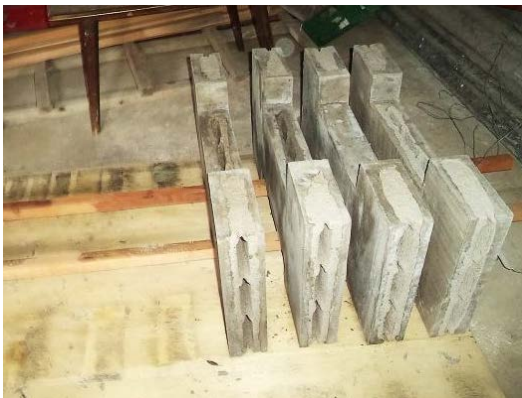
Foto. 32. Macro elementos modulares tipo 3 terminados.
