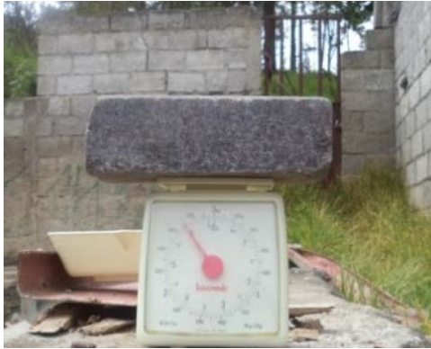
Foto. 28. Pesaje de adoquines.
