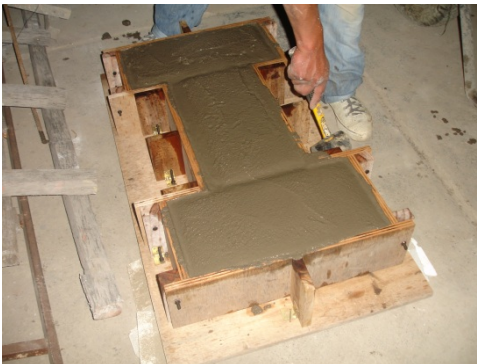
Foto.21. Extracción de aire mediante golpes con martillo de goma.
