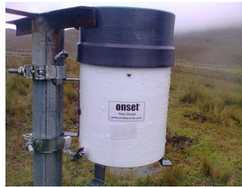
Figura 5: Pluviógrafo ONSET, tipo balancín.
