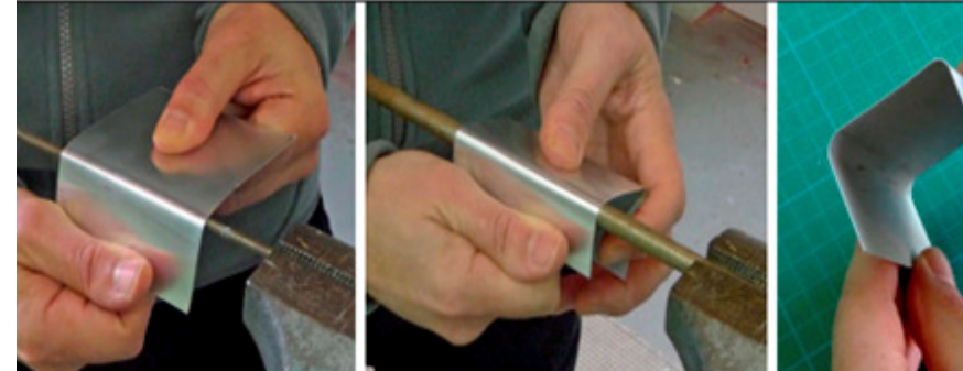
Imagen 57. Plegado de chapa metálica
