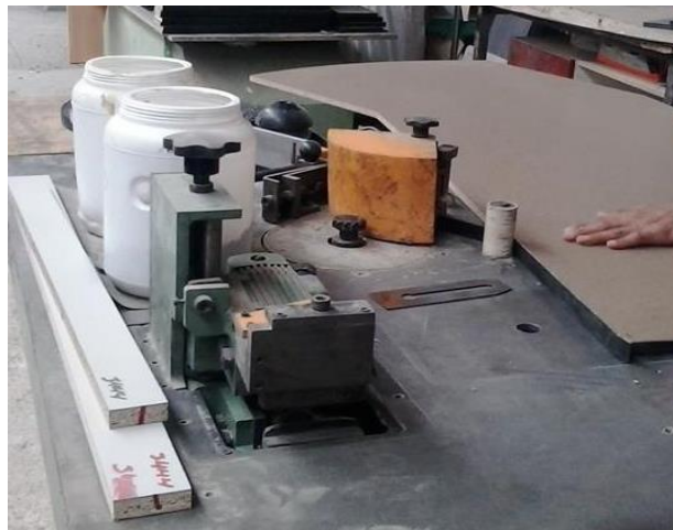
Figura 9. Proceso de pegado de canto curvo (Autor)
