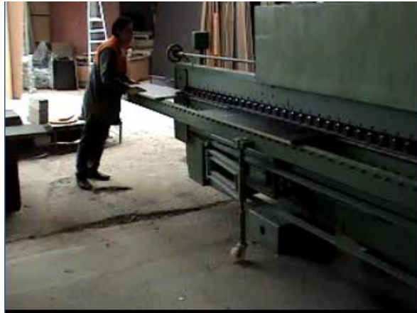
Figura 8. Proceso de enchapado de tableros (Autor)
