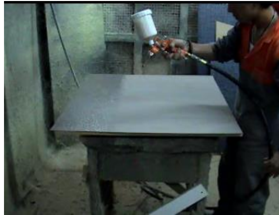
Figura 10. Proceso de aplicación de pegamento (Autor)
