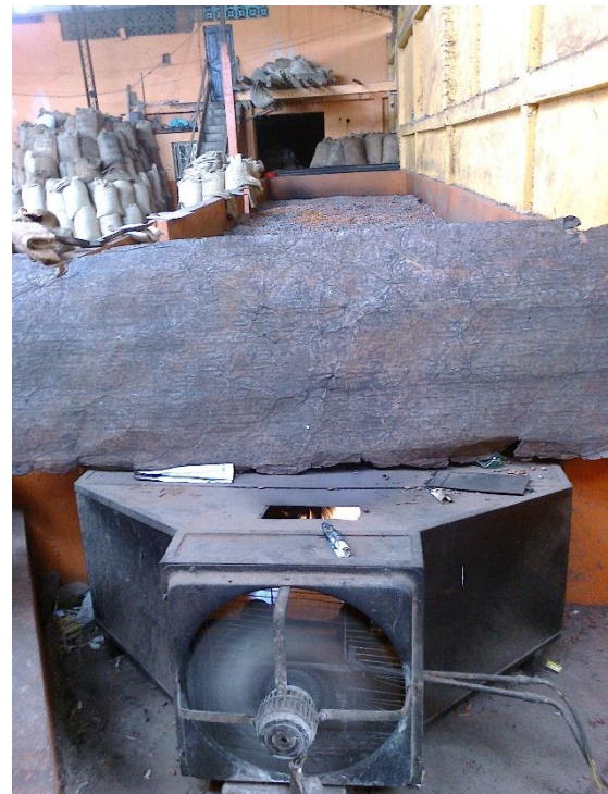
Figura 2. Secado del cacao en grano, en secador a GLP. Ciudad de Naranjal. 2014. Fuente propia.
