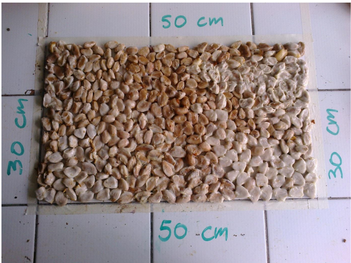
Figura 11. Determinación de la superficie específica del cacao en grano para el secado. Ciudad de Cuenca. 2014. Fuente propia.
