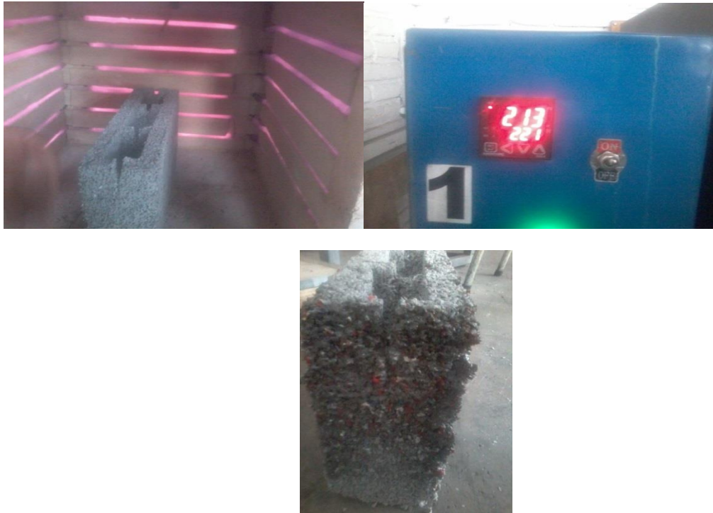
Ilustración 7.- Prueba de Resistencia al Fuego
