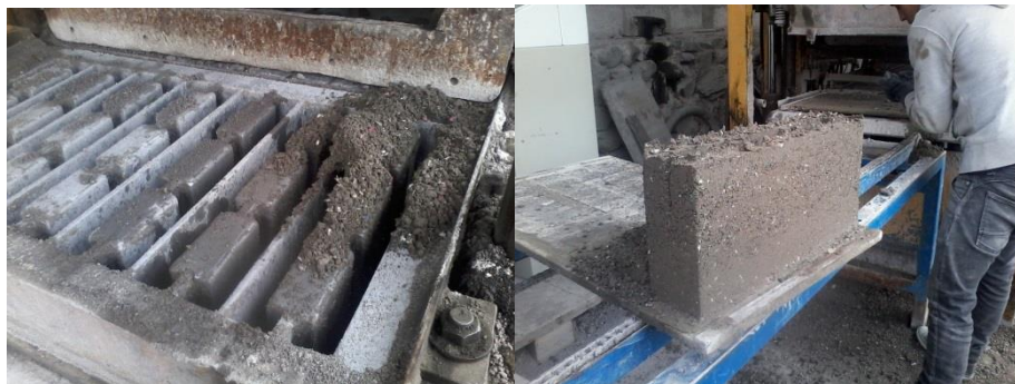
Ilustración 2.- Formación de los Bloques Fotografiado por: Las Autoras Lugar: Bloquera INDUBLOCK (Av. De los Cerezos s/n y Av. Ordóñez Lasso)
