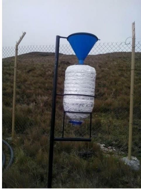
Imagen 1 Colector de agua de precipitación.
