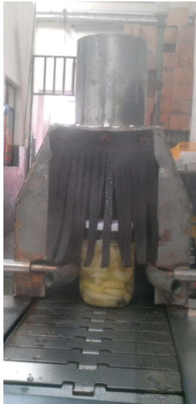
Figura 2.27: Evacuado con vapor de agua.
