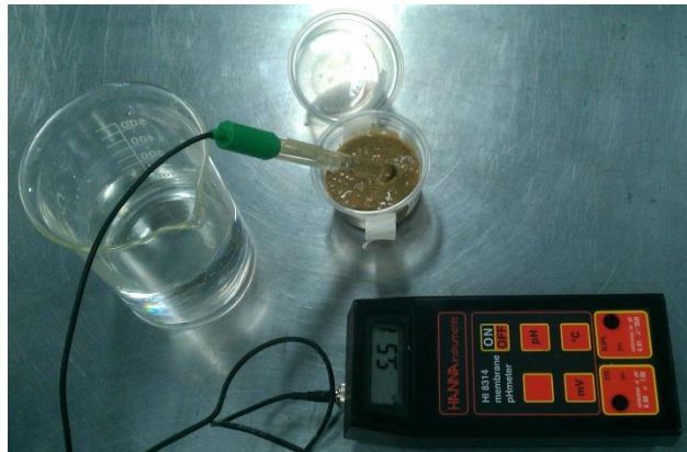
Figura 2.15: Medida del pH en enlatados de menestra.
