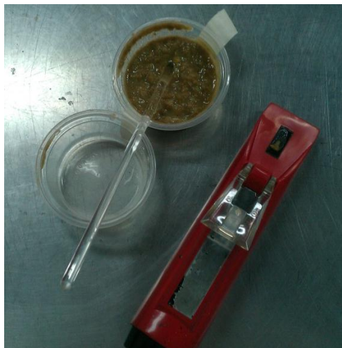
Figura 2.16: Medida de Grados Brix en enlatados de menestra.
