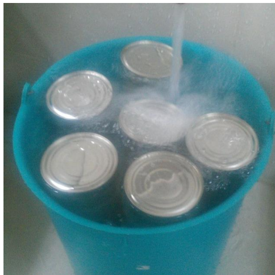
Figura 2.13: Figura 2.13 Enfriado de latas.
