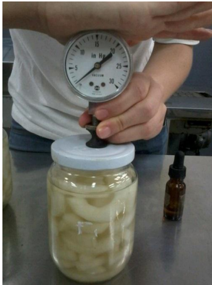
Figura 2.28: Medida del vacío en encurtidos.
