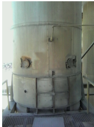
Foto 5. Punto de muestreo N°2: Ducto de gases de salida del pre-calentador (Downcomer)
