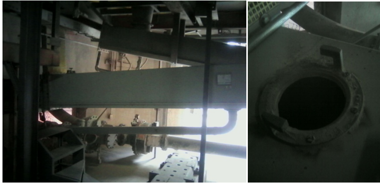
Fotos 3 y 4. Punto de muestreo N°1: Salida de la alimentación de los silos de almacenamiento (aerodeslizador).
