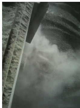
Fotos 26. Punto de muestreo N°15: Zona en la que se determina la cantidad de polvo de clinker recuperado por el filtro (F25) del enfriador.
