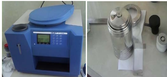
Fotos 28 y 29: Bomba calorimétrica y sus implementos
