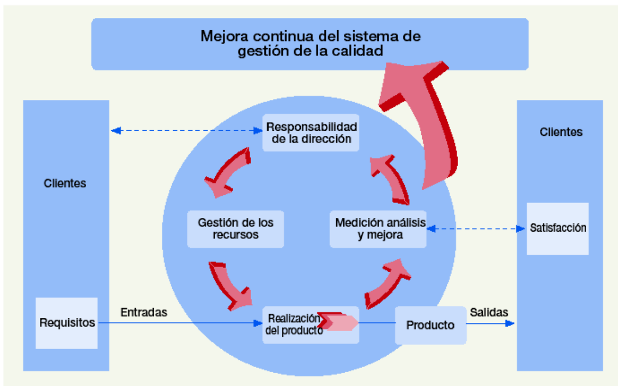
Figura 2 Modelo de un sistema de gestión basado en procesos Fuente: Icontec Internacional. (2008). NTC ISO 9001. Bogotá. Elaborado por: Icontec Internacional.
