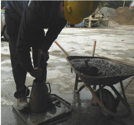
Figura 13. Imagen de compactación de la primera capa del hormigón fresco.
