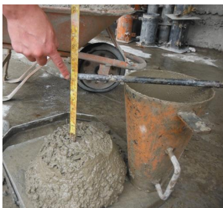
Figura 17. Imagen de la medición del asentamiento.
