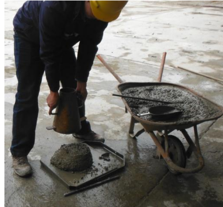
Figura 16. Imagen del levantamiento del cono de Abrams.
