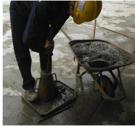
Figura 14. Imagen de la compactación de la tercera capa del hormigón fresco.
