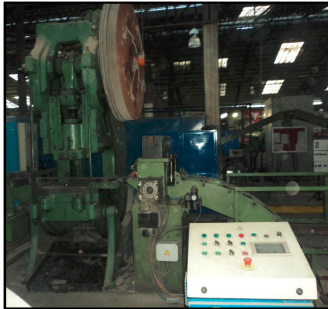
Figura 1.6: prensa de perfiladora con control numérico.
