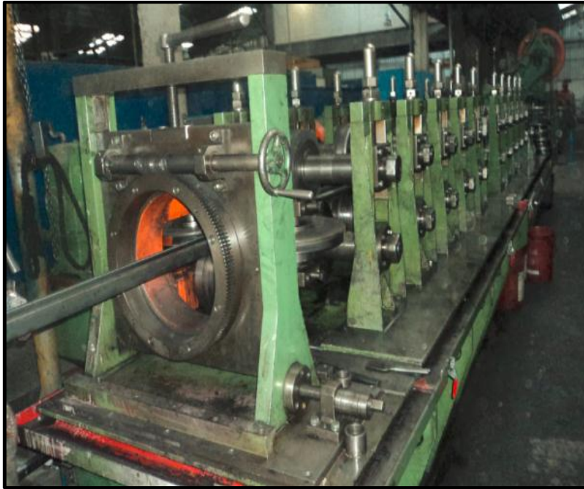
Figura 1. 7: Bancada conformadora de perfil.
