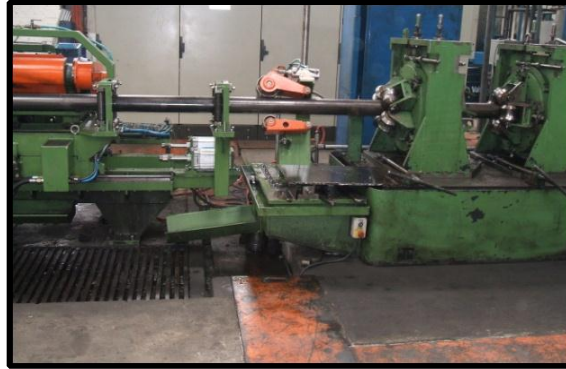
Figura 1.3: Conformado de tubos formadora 2.
