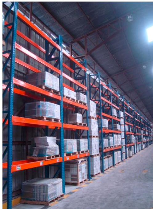
Figura 4.18: Racks de 5 niveles (2)
