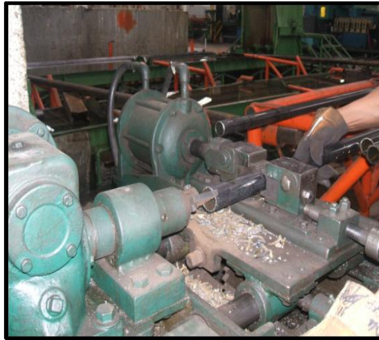
Figura 1.10: Biselado de tubo en rebabadora 1
