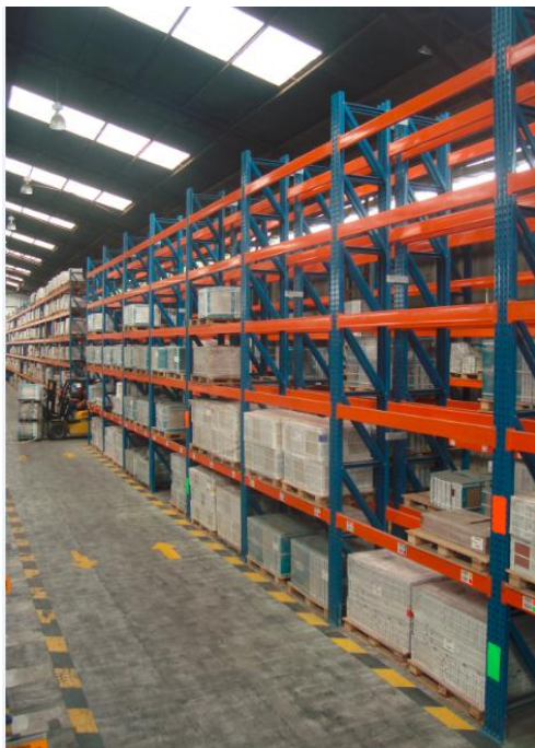
Figura 4.17: Racks de 5 niveles (1)
