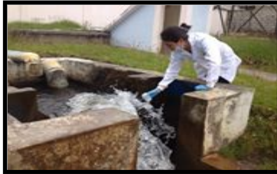
Foto 9: Toma de muestra en la entrada del agua a la planta.
