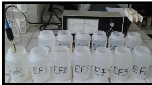
Foto 13: pH-metro/modelo 301-Determinación de pH.
