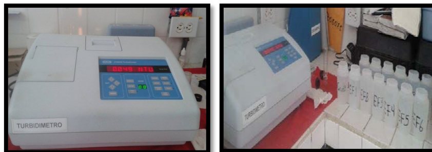
Foto 14: Equipo HACH 2100AN- para determinación de Color y Turbiedad.
