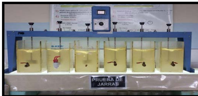
Foto 5: Prueba de las Jarras - Planta de tratamiento de agua potable Uchupucun.
