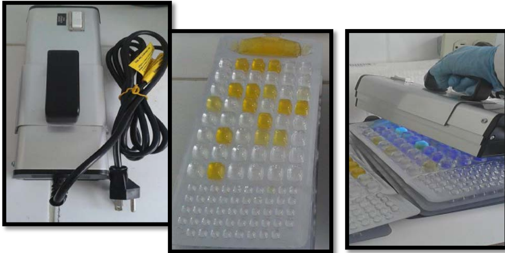
Foto 18: Lámpara UV para determinar fluorescencia (Coliformes fecales)
