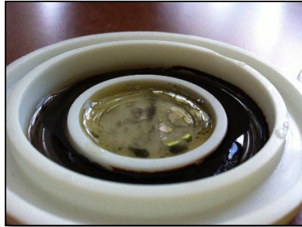
Figura 12: Película platinada metálica en la superficie de la cámara central.
