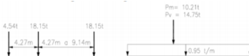
Ilustración 2.11 Distribución del peso del camión de diseño HS 25-44, (Oficial, 2010)
