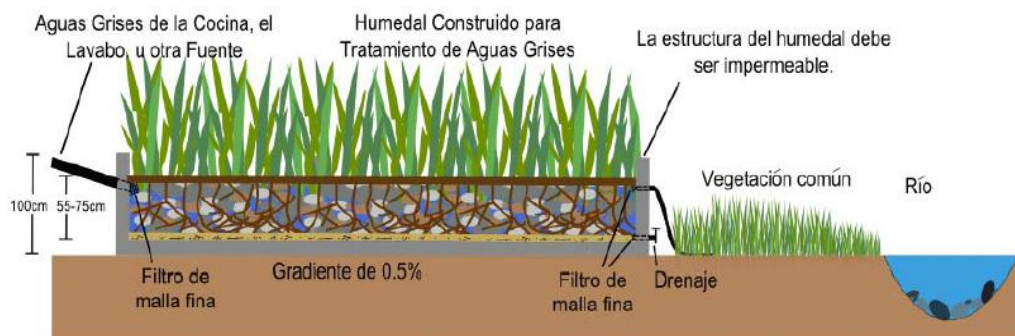
Figura 5: Sistema subterráneo típico de humedal artificial.
