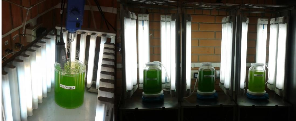
Figura 3.1 Fotobioreactores implementados en el laboratorio, con los respectivos sensores de oxígeno y pH
