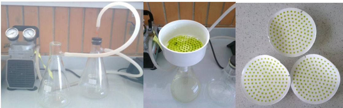
Figura 3.16 a) Bomba de vacío b) Embudo de porcelana c) Filtros Whatman ( \varphi 110mm)
