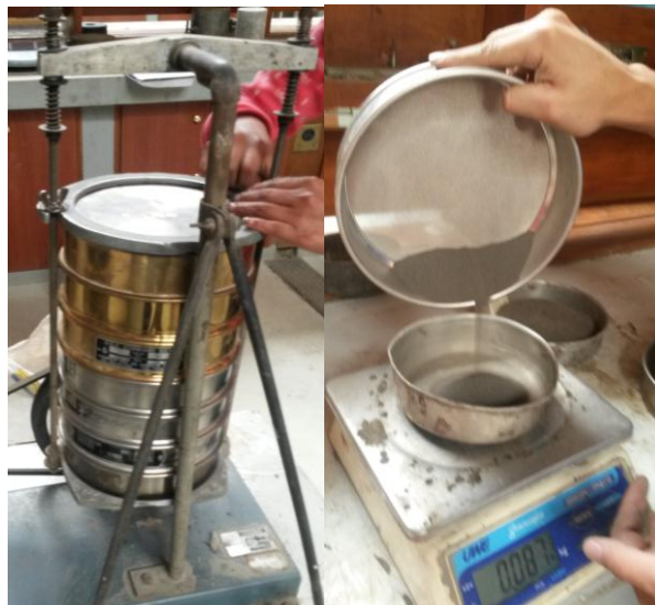
Figura 2.3. Agitador mecánico para realizar la granulometría del suelo.
