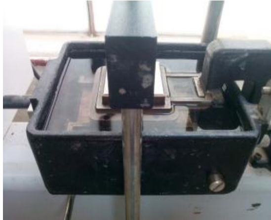
Figura 2.12. Saturación de la muestra en el equipo de corte.
