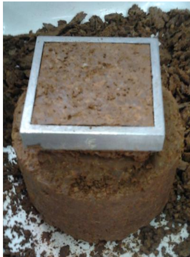
Figura 2.11. Preparación de la muestra en el anillo de 6 cm de lado.
