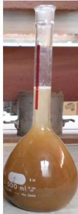
Figura 2.4. Ensayo Gravedad Específica.
