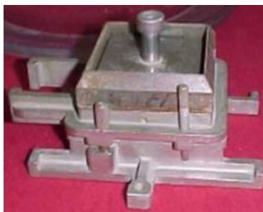
Figura 2.10. Caja metálica y equipo para realizar el ensayo de corte directo, Laboratorio Facultad de Ingeniería.
