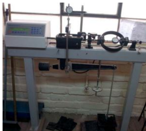
Figura 2.10. Caja metálica y equipo para realizar el ensayo de corte directo, Laboratorio Facultad de Ingeniería.
