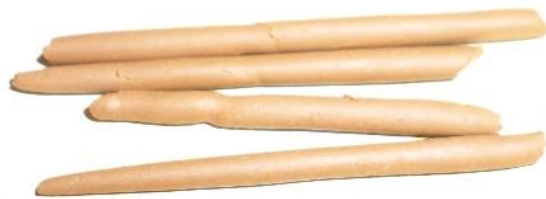
Figura 2.7. Cilindros obtenidos a partir del ensayo, para determinar el límite plástico del suelo.
