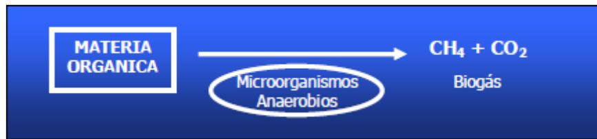
Figura 2-4 Esquema de la degradación biológica de la Materia Orgánica
