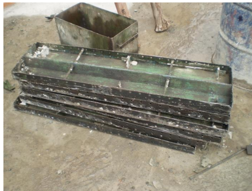
Foto 43. Módulos de metal utilizados en encofrados de columnas.
