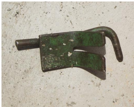
Foto 44. Ganchos utilizados para unir los módulos en el encofrado.
