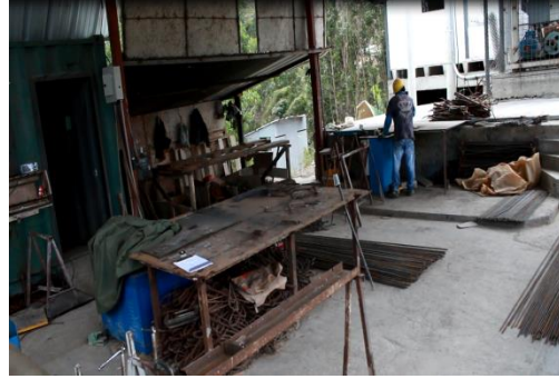
Foto 62. Sector de la fábrica destinado para doblar las varillas utilizadas para estribos de los elementos estructurales, fábrica Carrasco RFV Construcciones.
