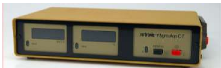
IMAGEN 3. Equipos para determinar la actividad acuosa de los alimentos
