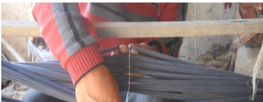
Ilustración 7 imagen en la que se demuestra cómo se agrupa los hilos para cada diseño; fotografía autor
