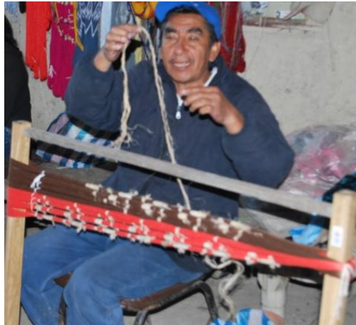
Ilustración 12 Una foto en la cual se admira el amarrado con cabuya previo al teñido del hilo; fotografía autor
