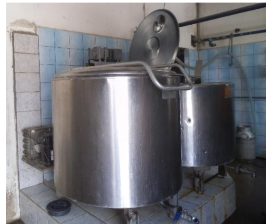
Imagen 6 Tanques de enfriamiento
