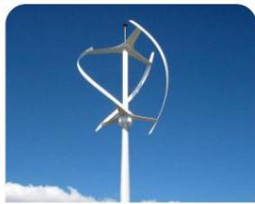
Turbinas eólicas de eje vertical (TEEV)
