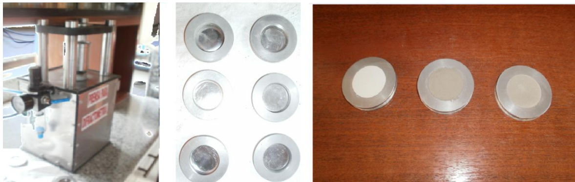
FIGURA 28. Imagen de la prensa hidráulica y pastillas prensadas para el análisis por DRX.
