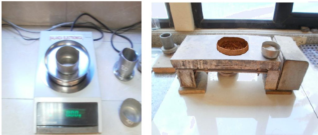
FIGURA 21. Equipo e instrumental para la determinación de la humedad de la puzolana.
