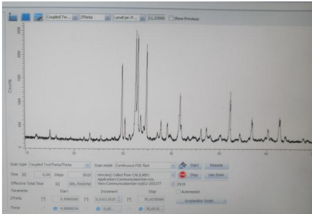
FIGURA 14. Esquema de un difractograma de una muestra de puzolana en el equipo de DRX. Fuente: Equipo de difracción RX D2 PHASER.
