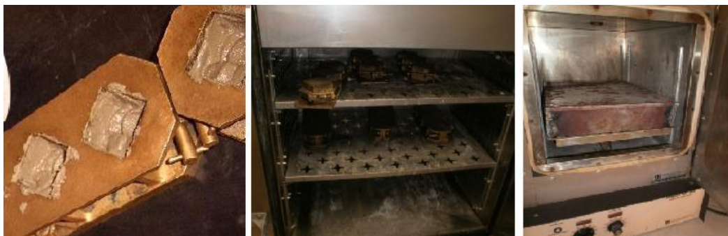
FIGURA 26. Equipo e instrumental para el llenado y almacenamiento de morteros.
