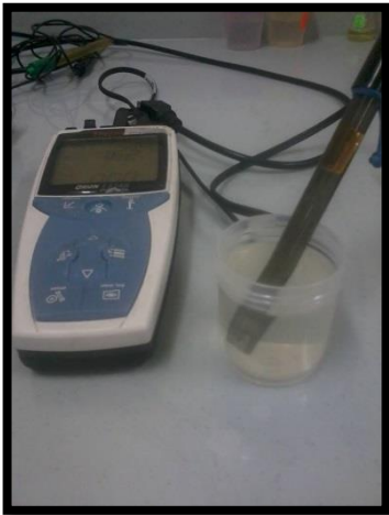
Fotografía 7: Equipo para medir pH
