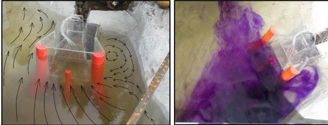
**Figura 10.-** Vista frontal del flujo de aproximación a la bocatoma, con el nivel máximo de operación del embalse. Nótese el sentido y patrones de flujo en las fronteras de la obra
