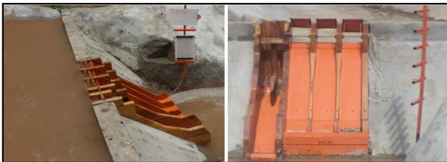
**Figura 4.-** Cuerpo de la Presa (Izq.). Vertederos de excesos y desagüe de fondo (Der.)
