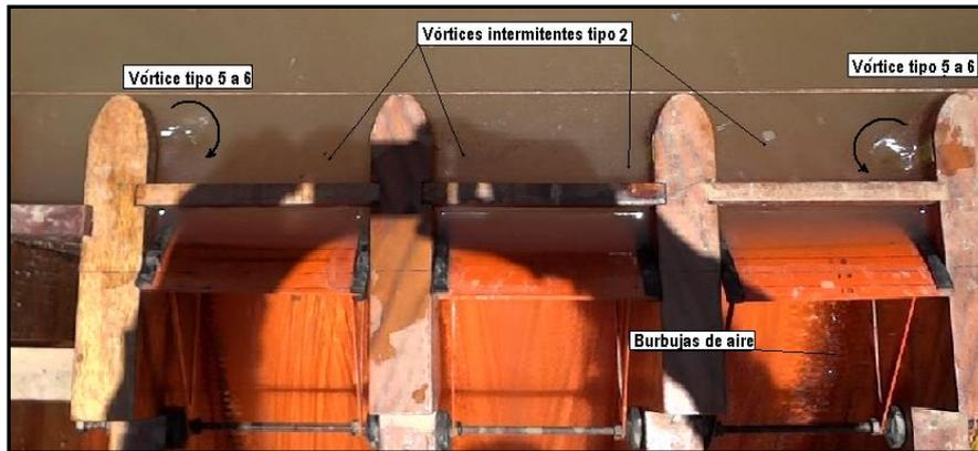
**Figura 6.-** Vórtices generados en la operación con tres compuertas
