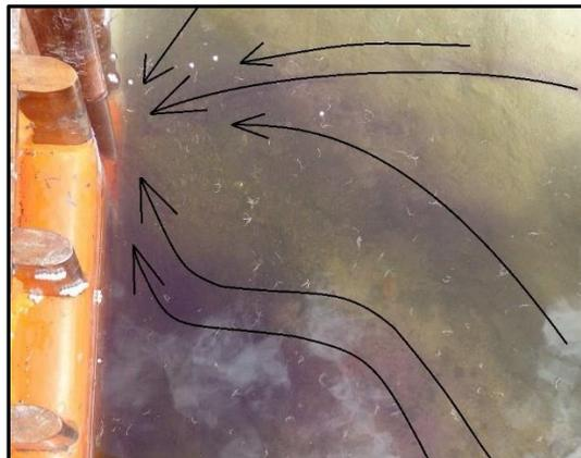
**Figura 9.-** Vista del flujo junto al paramento de la presa con los desagües totalmente abiertos. No se observa formación de vorticidad.
