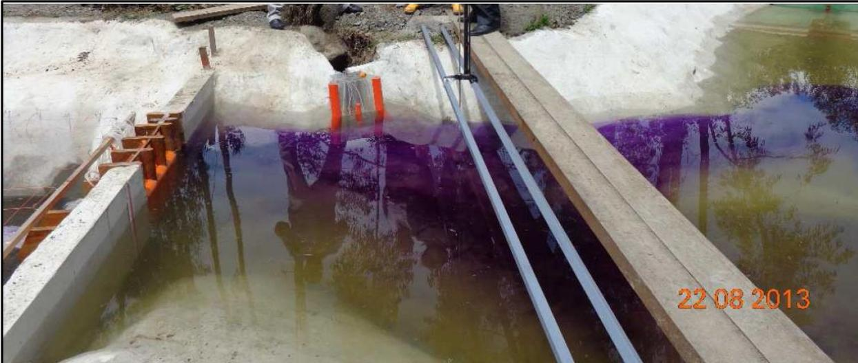
**Figura 8.-** Vista del flujo de aproximación hacia el embalse. Desagües de fondo totalmente abiertos. Nótese el flujo preferencial hacia la margen derecha
