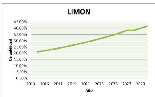
Figura 46: Cargabilidad en el transformador T231
