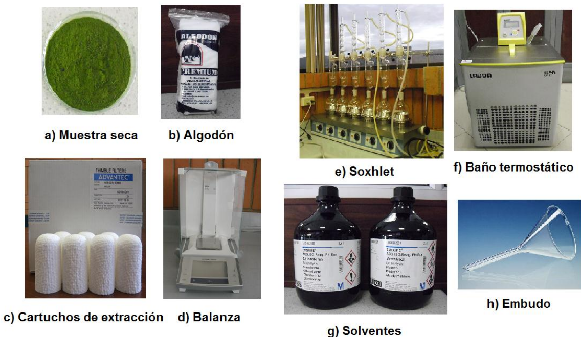
Figura 3.27 Materiales usados para la extracción de lípidos
