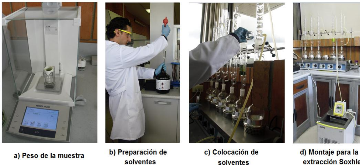
Figura 3.28 Montaje para la extracción Soxhlet
