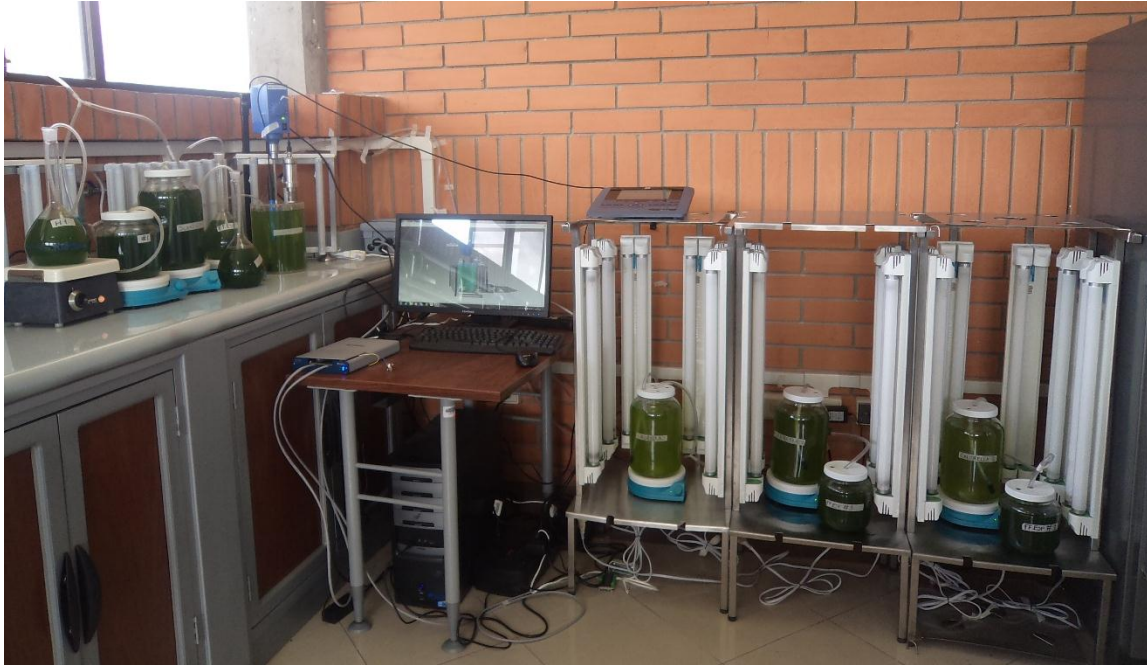
Figura 4.5 Implementación de cultivos de microalgas y respirómetro
