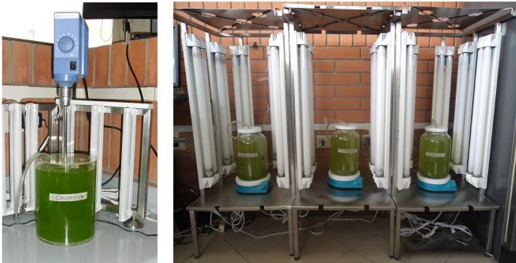
Figura 3.5 Montaje del cultivo de microalgas
