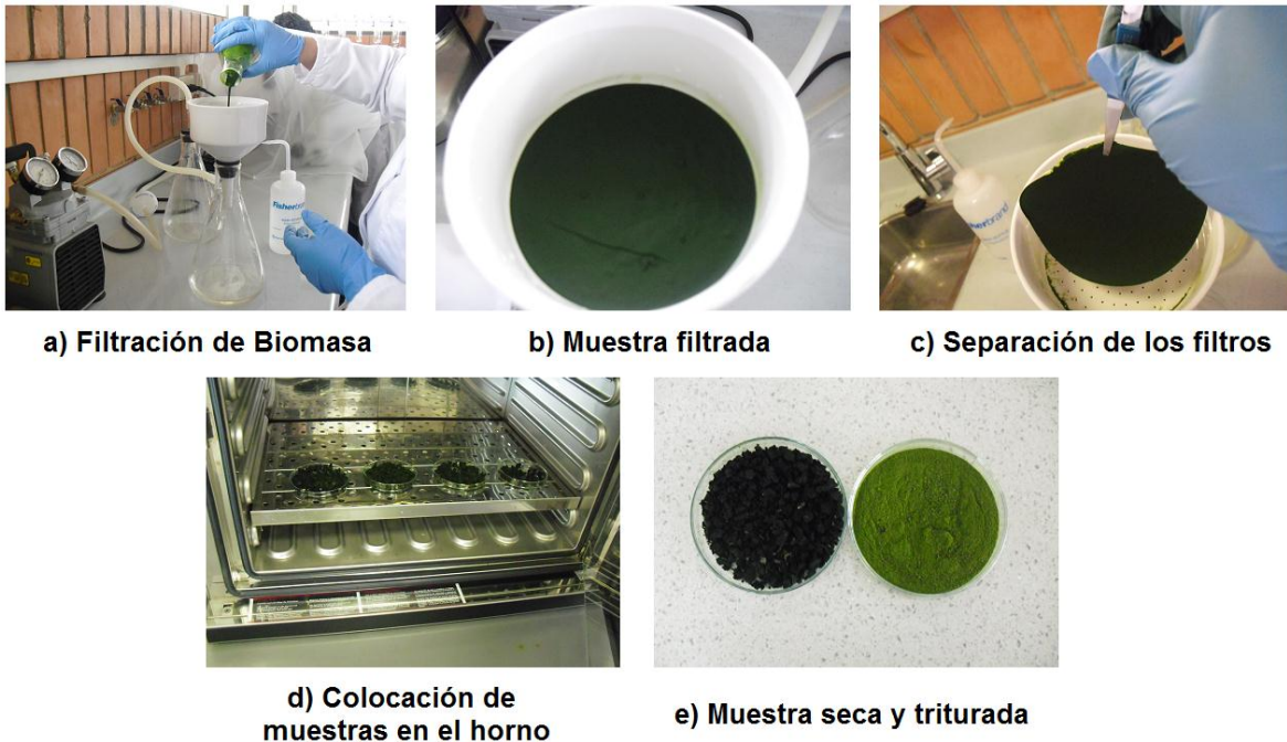
Figura 3.17 Procedimiento de filtración y secado de la biomasa algal
