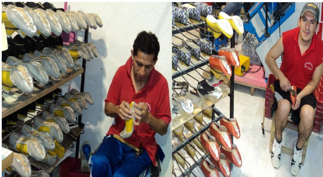
**UNA VEZ UNIDAS TODAS LAS PARTES SE CONTINUA MONTANDO TODAS LAS PARTES A UN MOLDE, PARA DARLE FORMA AL ZAPATO.**
