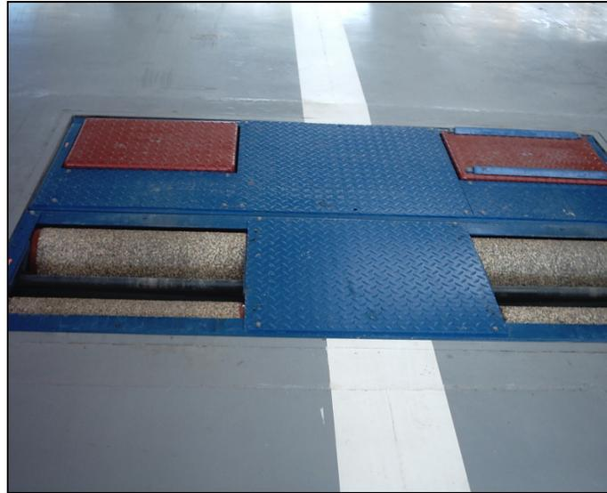
En la foto se observan las planchas de suspensión en color rojo, y los rodillos del frenómetro en la parte posterior.
