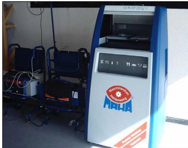
En la foto se observan de izquierda a derecha el opacímetro, el analizador de gases y la consola
